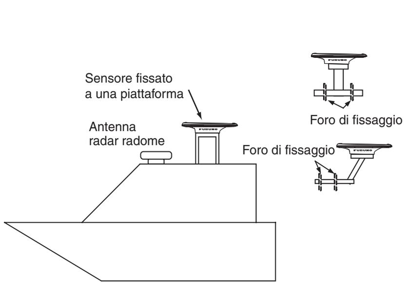
I fori di fissaggio devono "circondare" il sensore. Inoltre, fissare il polo di montaggio all'angolo destro.
